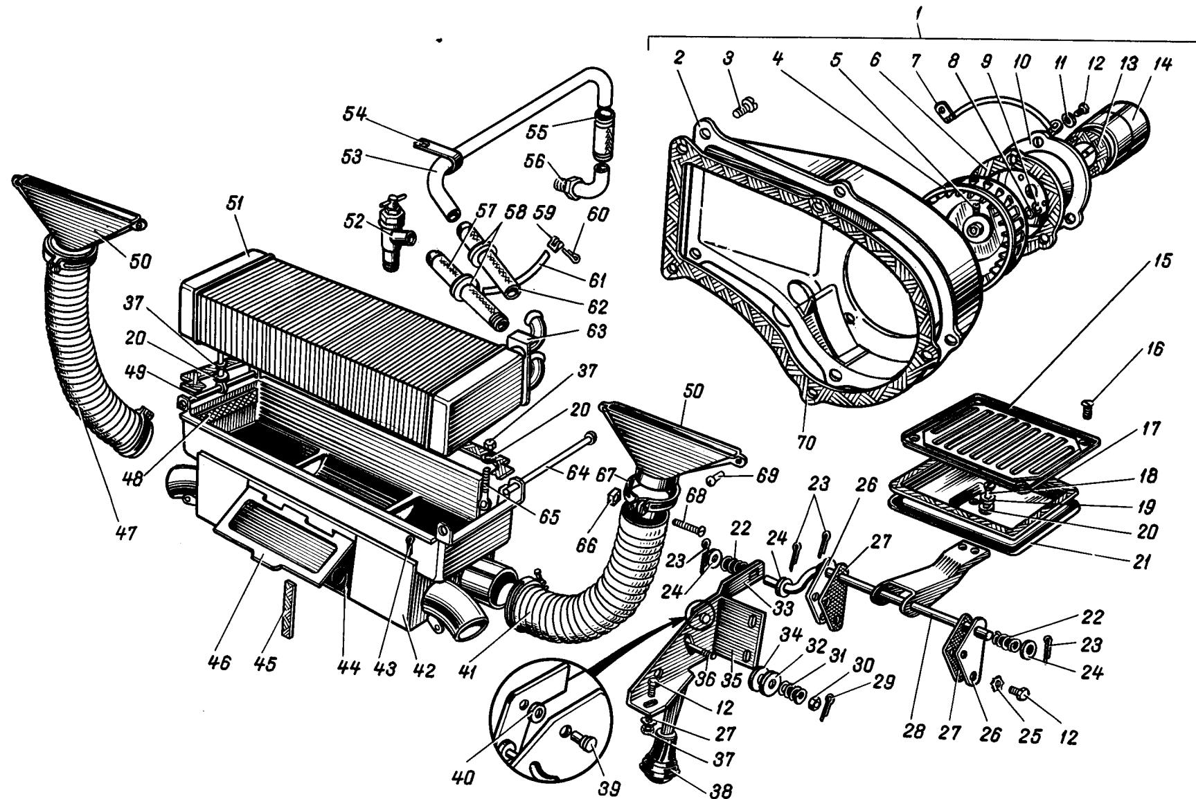
Рис. 64. Вентиляция, отопление и обогреватель ветрового стекла кузова
